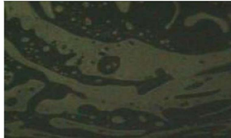
**3,4- Mescole a fase continua bituminosa, le macchie gialle di polimero sono inglobate nella matrice di bitume, la concentrazione di polimero è insufficiente e/o il bitume è incompatibile**
